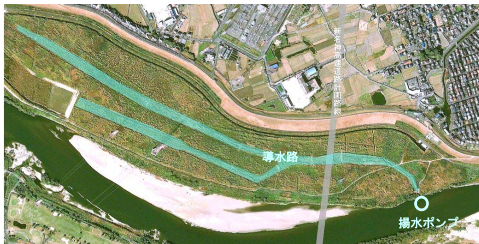
図 2.3.4.1 導水路の状況
