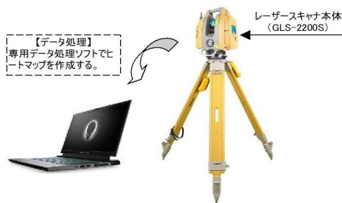
図-1 3D レーザースキャナ測定機
