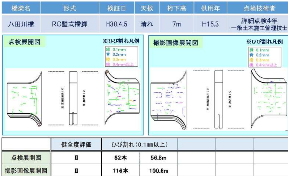
図-3. 10. 1 八田川橋（橋脚）検証結果
