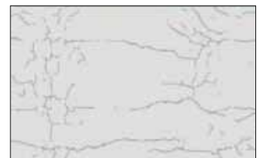
ひび割れ展開図作成イメージ
