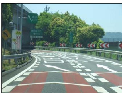
《薄層舗装による速度抑制》
