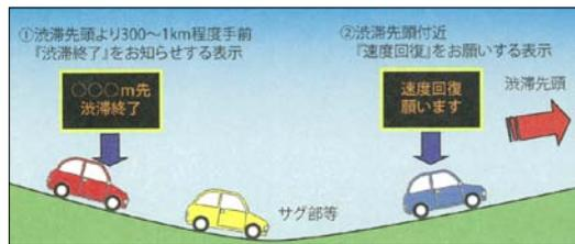
《LED標識による速度回復状況提供の概念図》
