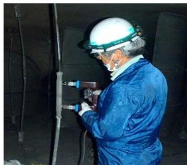
磁粉探傷試験により健全性を確認
