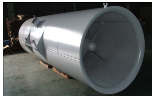
《トンネルジェットファン(補修後)》
