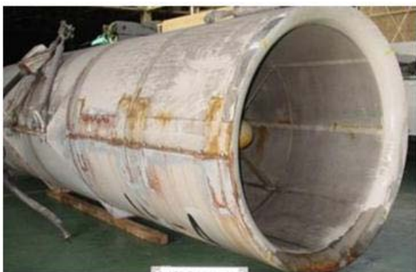
《トンネルジェットファン(補修前)》
