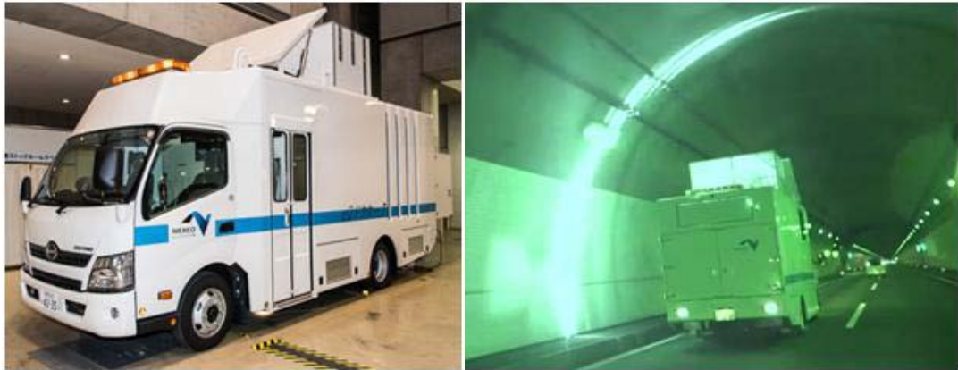
《トンネル覆工調査》
