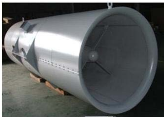
《トンネルジェットファン(補修後)》
