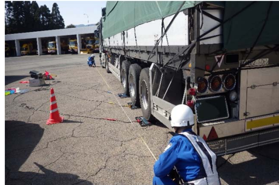
《車両の全長や重量の計測》
