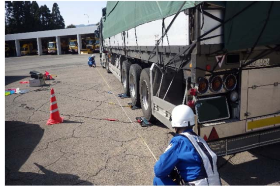
《車両の全長や重量の計測》
