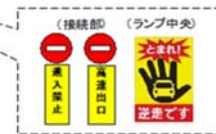
《IC 出口: 矢印路面標示＋注意喚起標識》
