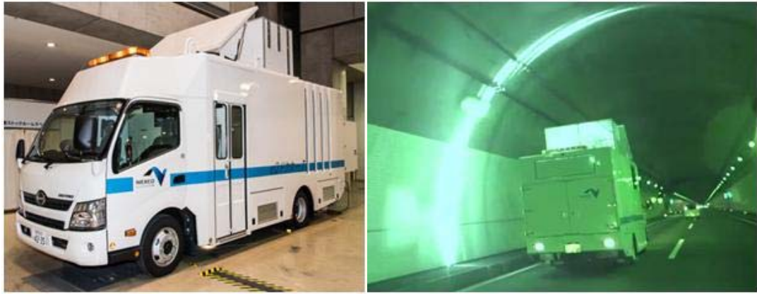
《トンネル覆工調査》
