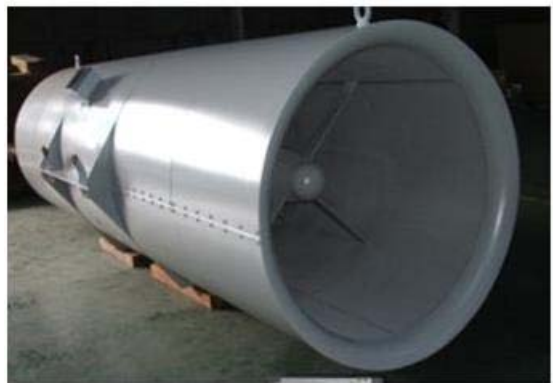
《トンネルジェットファン(補修後)》
