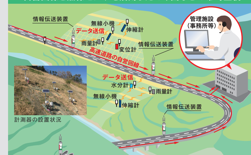
自営回線と無線センサを活用したのり面などの常時監視
