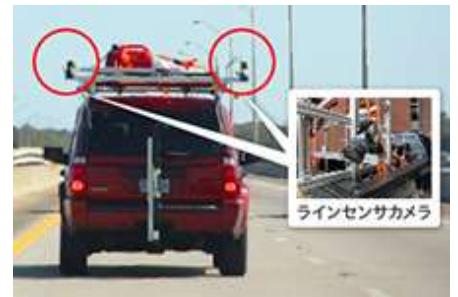
ラインセンサカメラによる コンクリート床版の撮影
