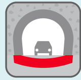
トンネル (インバート設置)
