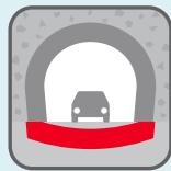
トンネル (インバート設置)
