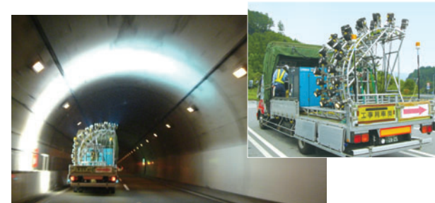
ハイビジョンカメラを用いたトンネル目地部の点検
