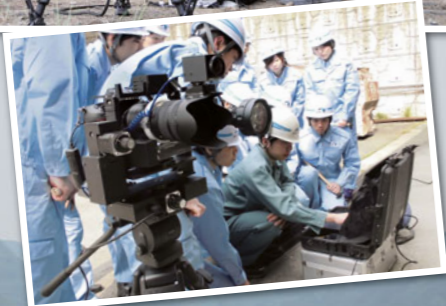
撮影した画像から橋梁のひび割れを発見するauto CIMA System
