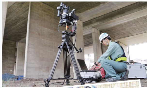
撮影した画像から橋梁のひび割れを発見するauto CIMA System
