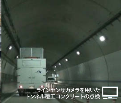
撮影した画像から損傷箇所を発見する auto CIMA System
