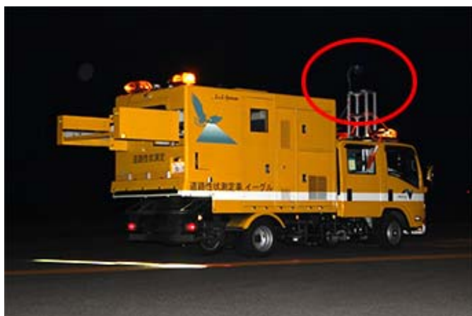
走行しながら赤外線カメラで撮影し熱画像を取得
