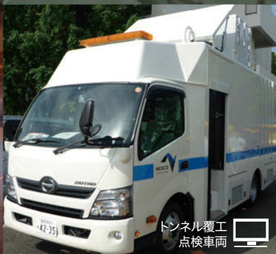
ラインセンサカメラを用いたトンネル覆工コンクリートの点検
