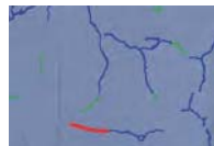
ひび割れの進展 (赤線部)
