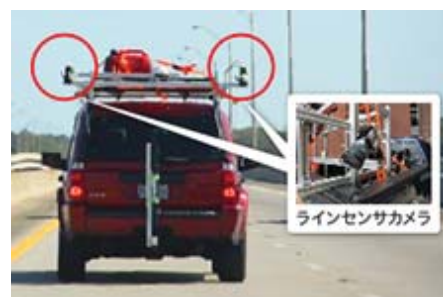
ラインセンサカメラによる コンクリート橋床版の撮影
