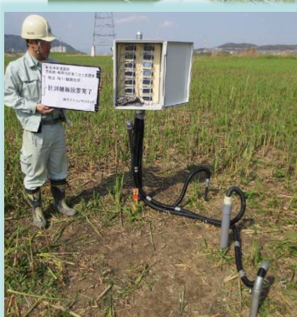
土壌水分計及び地中温度計の設置
