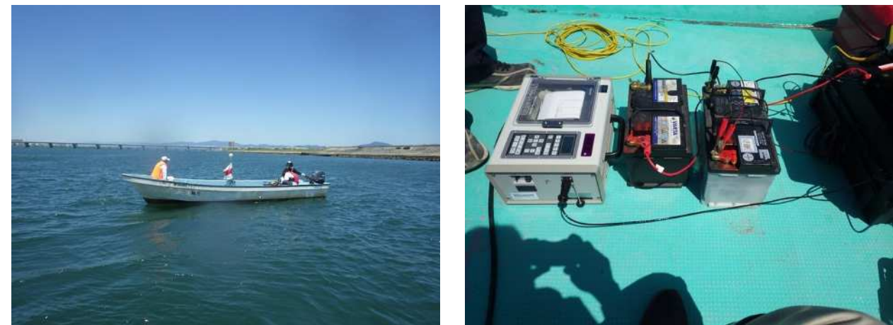
図 4.2-4 地形調査(深浅測量)の実施状況
