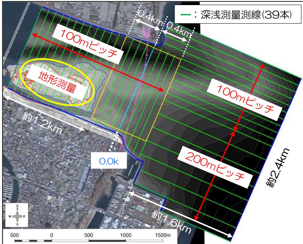
※測線の間隔は100mを基本とし、沖合の河口テラスより以南は200m間隔の測線とする。
